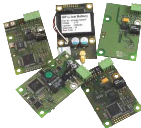
Фиг. 35 Grundfos CIM модули
